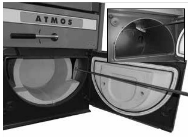
Otevřený spodní prostor kotle s kulovým prostorem a ukázkou vyhrabování popela pomocí pohrabáče z boků spalovací komory Čištění horní příkladací komory pohrabáčem
